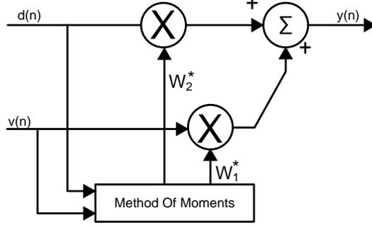
**Fig. 54: Dual-Tap IQI Compensation Method**
