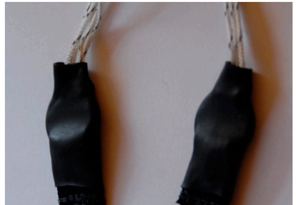
Obere Ringe mit Schrumpfschlauch abdecken.
