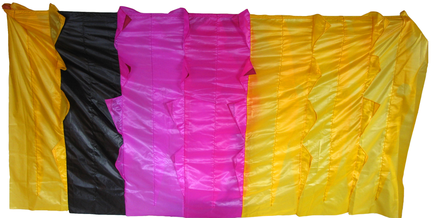
Das fertige Unterteil von unten gesehen. Pro Rippe treten vier Flares hervor, in die später die Fangleinen eingeknotet werden.
