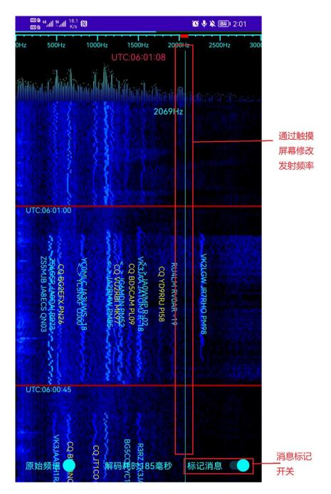
关于频率的一点提示。虽然正常人的人耳能听到的声音频率最大范围是 20Hz~20000Hz, 但是, 由于 FT8 模式 使用单边带发射, 调制最大带宽是 3Khz, 现在有些业余电台设备使用的是无源窄带滤波器, 带内不平坦, 当音频设置小于 400Hz, 大于 2600Hz 时发射功率急剧下降。所以选择发射的声音频率, 建议在300Hz~2800Hz 之间。
