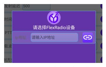
如果 FlexRadio 的电台在本局域网内,FT8CN 会列出该电台的信息,如果不在相同的局域网内,可以直接输入 FlexRadio 电台的 IP 地址进行控制。
