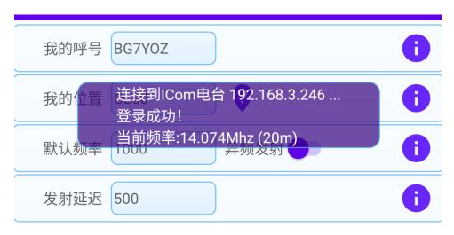
注意! 在实际测试中, IC-705 电台对网络传输的要求很高,路由器性能不佳很可能会因为丢包而影响发射音频效果,建议使用电台连接 FT8CN 手机热点的方式进行网络控制,或直接连接电台的热点。
