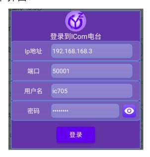
输入正确的 IP 地址、端口、用户名和密码(以上参数可以到 iCom 电台的设置中查找)后,点击"登录"按钮即可对电台控制。连接成功后会有如下提示:
