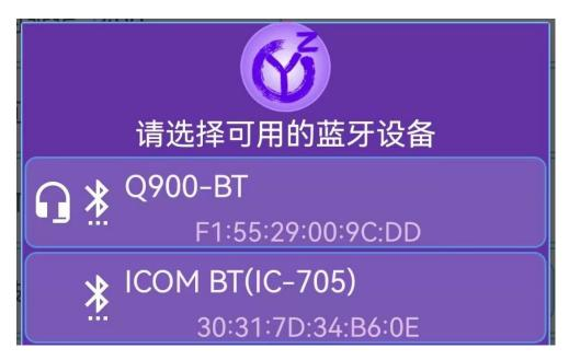
蓝牙连接,仅仅是对电台的控制,并不包括蓝牙音频,蓝牙音频与蓝牙串口是相互独立存在的,也是就说,使用蓝牙音频,可以使用有线连接对电台控制,也可以用蓝牙串口控制。或者,使用蓝牙串口控制电台,同时用有线或 MIC 直接采集声音。如果电台支持蓝牙串口,也支持蓝牙音频,且电台的蓝牙音频支持从机模式(目前已知国赫 Q900 同时具备),FT8CN 就可以同时使用蓝牙串口和蓝牙音频进行 FT8 通联,这时手机可以完全摆脱有线的连接,真正实现无线连接。BG7IKK 尝试设计使用蓝牙模块对不具备蓝牙的老电台做控制(包括音频),目前已经成功实现,具体实现方案可以到哈啰 CQ 论坛中查找。
